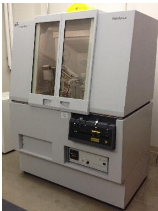
Рисунок 33 – Дифрактометр X'pert MPD PRO PANalytical
