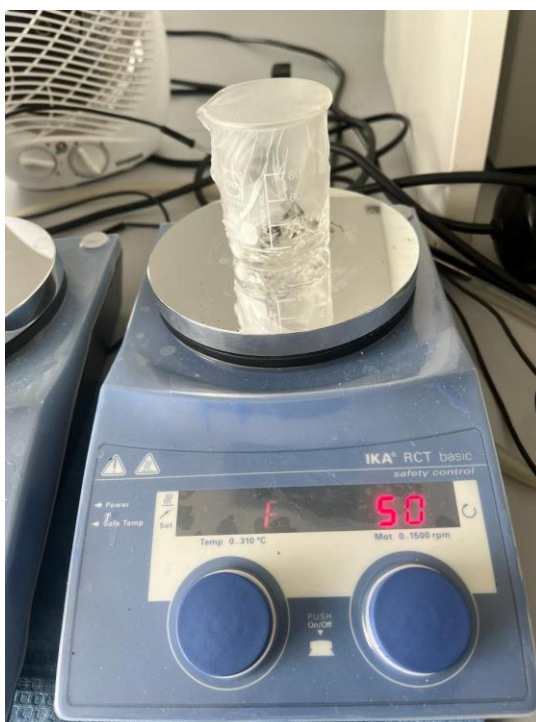
Рисунок 14 – Установка для синтеза ZnO
